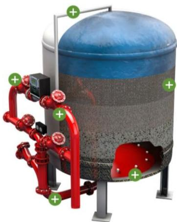
2. В стандартной комплектации управление диафрагменными клапанами фильтров осуществляется с помощью **гидравлических приводов, использующих для переключения циклов давление входящей исходной воды**. Отпадает необходимость дополнительного использования сжатого воздуха либо электроэнергии для управления клапанами и соответствующего вспомогательного оборудования. Конструкция применяемых диафрагменных клапанов с гидроприводами максимально проста и надежна в эксплуатации.
