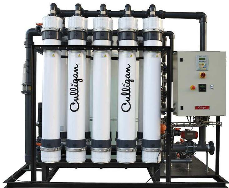
Ультрафильтрация - по рейтингу фильтрации воды занимает промежуточное положение между нанофильтрацией и микрофильтрацией. Ультрафильтрационные мембраны имеют размер пор от 20 до 1000 А (или 0,002-0,1 мкм) и позволяют задерживать тонкодисперсные и коллоидные примеси, макромолекулы (нижний предел молекулярной массы составляет несколько тысяч), водоросли, одноклеточные микроорганизмы, цисты, бактерии и вирусы и т.д.
