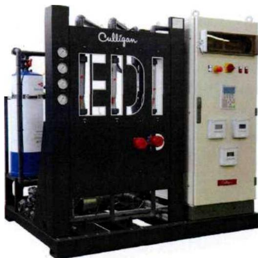
Электродеионизаторы предназначены для производства сверх чистой воды без использования реагентов, с использованием сочетания рулонных мембран и ионообменных смол.
